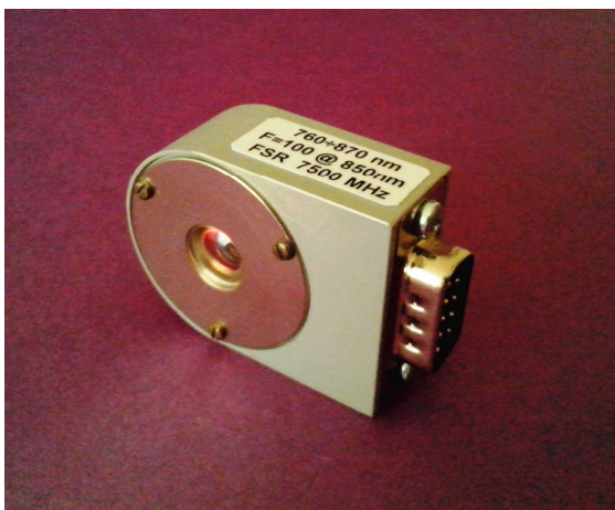
Рис.7. Внешний вид интерферометра SCC-7500, типичные резонансы пропускания сканирующего интерферометра SCC и форма отдельного резонанса (на врезке).
