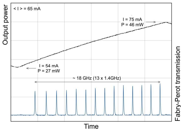
**Рис.5. Мощность ECDL-8620R (верхняя кривая) и пропускание конфокального интерферометра (нижняя кривая) при синхронном сканировании дифракционной решетки и тока ЛД.**
