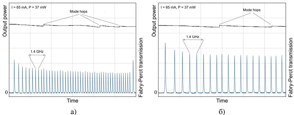
**Рис.4.** Зависимости выходной мощности лазера от напряжения на пьезоэлементе при постоянном токе LD (верхние черные кривые). Внизу – пропускание конфокального интерферометра. Напряжение меняется линейно со временем (показан только один склон модулирующего сигнала), ток лазерного диода не меняется.
