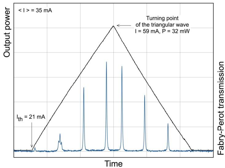
**Рис.3. Зависимость выходной мощности лазера от тока инжекции** (верхняя черная кривая). Ток лазерного диода модулируется симметричным треугольным сигналом, напряжение на пьезоэлементе не меняется. Нижняя синяя кривая показывает пропускание конфокального интерферометра.
