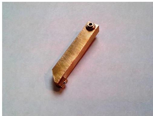
**Рис.6. П-образный шлицевой ключ из ремонтного комплекта.**
