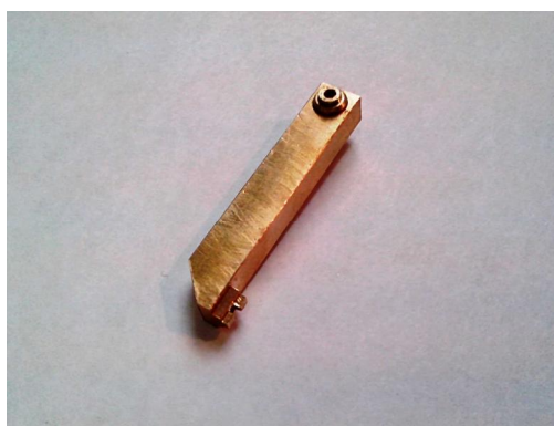
Рис.6. П-образный шлицевой ключ из ремонтного комплекта.
