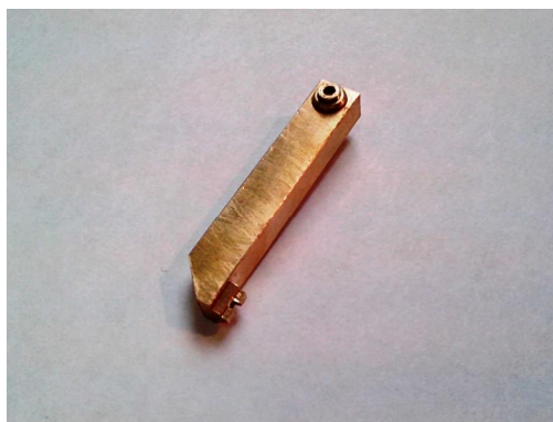
Рис.4. П-образный шлицевой ключ из ремонтного комплекта.
