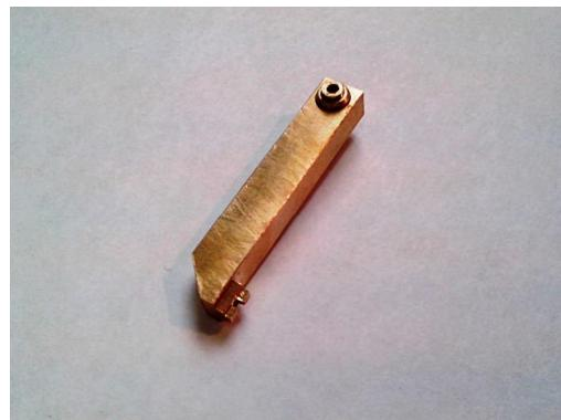
**Рис.6. П-образный шлицевой ключ из ремонтного комплекта.**
