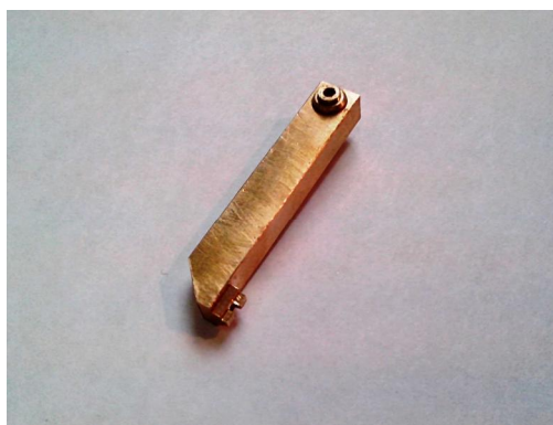
Рис.6. П-образный шлицевой ключ из ремонтного комплекта.
