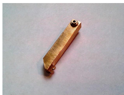
Рис.6. П-образный шлицевой ключ из ремонтного комплекта.
