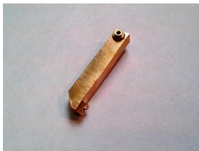
Рис.6. П-образный шлицевой ключ из ремонтного комплекта.
