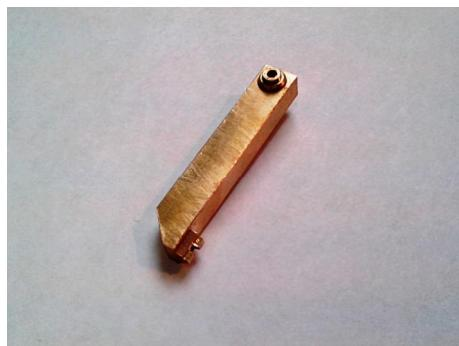
**Рис.8. П-образный шлицевой ключ из ремонтного комплекта.**
