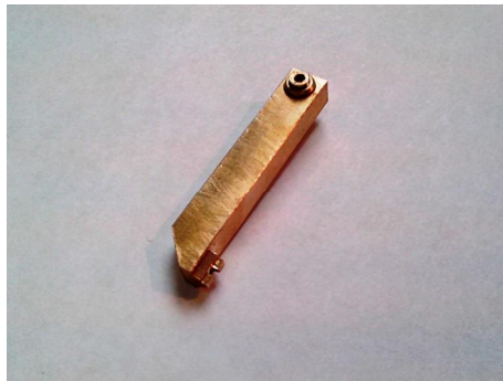
Рис.8. П-образный шлицевой ключ из ремонтного комплекта.
